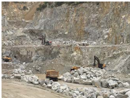
รูปที่ 2-7: การทำเหมืองแบบชั้นบันได
